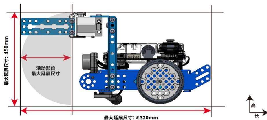
b. 机器人完全展开后，任意部分不得超出长320mm\*320mm\*450mm（长\*宽\*高）的立方体。
